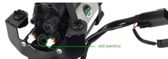
LOKALIZACJA ZAWORU WLOTOWEGO SPRĘŻARKI
