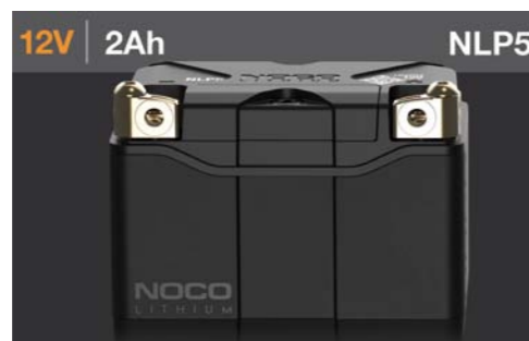
PODSTAWOWYM MODELEM NOCO LITHIUM JEST NLP5 (12 V/2 AH) O WADZE NIESPEŁNA 700 G I GABARYTACH: W PODSTAWIE 113/70 MM, WYSOKOŚĆ 88 MM. JEJĄ PRĄD ROZRUCHOWY WYNOŚI 250 A
