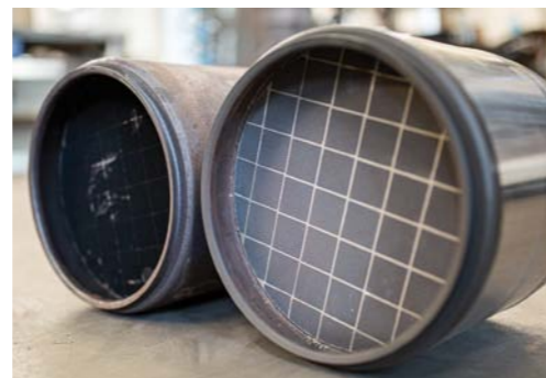
FILTR SAMOCHODU CIĘŻAROWEGO PRZED I PO REGENERACJI
