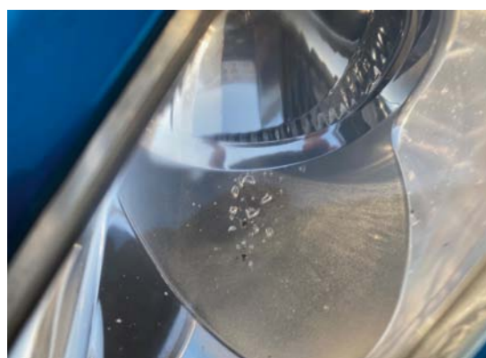
GDY TANIA ŻARÓWKA EKSPLODUJE EFEKTEM SĄ DROBINY SZKŁA I KONIECZNOŚĆ JEJ WYMIANY NA NOWĄ
