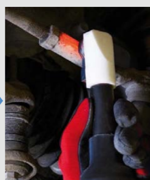
Indukcja z kontrolą procesu
