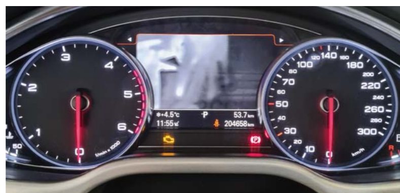
RYS. 2. OBSZAR WYŚWIETLANIA OBRAZU Z KAMERY TERMOWIZYJNEJ W SAMOCHODZIE AUDI
