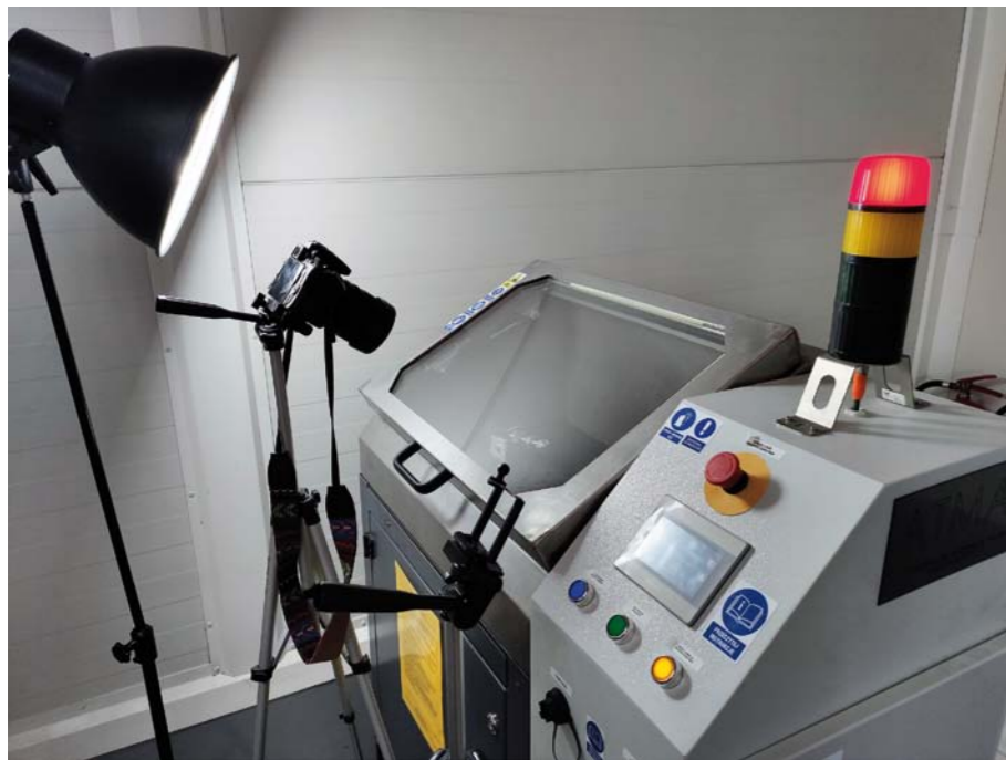
STANOWISKO DO TESTÓW CIŚNIENIOWYCH
