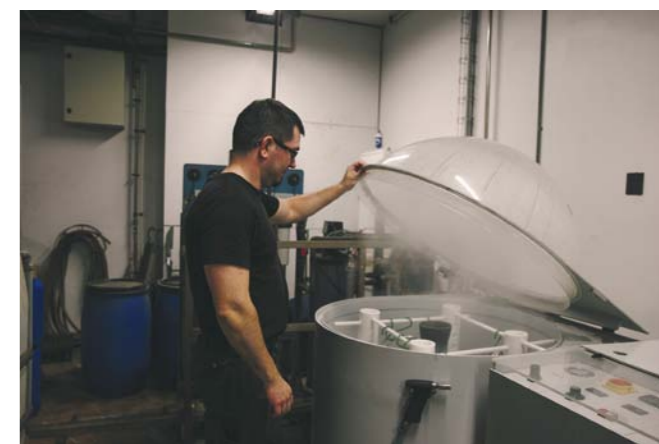
ZGODNIE Z NORMĄ ISO ZACISKI ELEKTRYCZNEGO HAMULCA POSTOJOWEGO PODDAWANE SĄ BADANIOM ZMĘCZENIOWYM I TESTOM W KOMORZE SOLANKOWEJ
