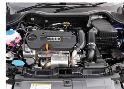
PODATNA NA LICZNE USTERKI, NAJMOCNIEJSZA WERSJA SILNIKA 1.4 TSI O MOCY 185 KM ZAMONTOWANA W AUDI A1
