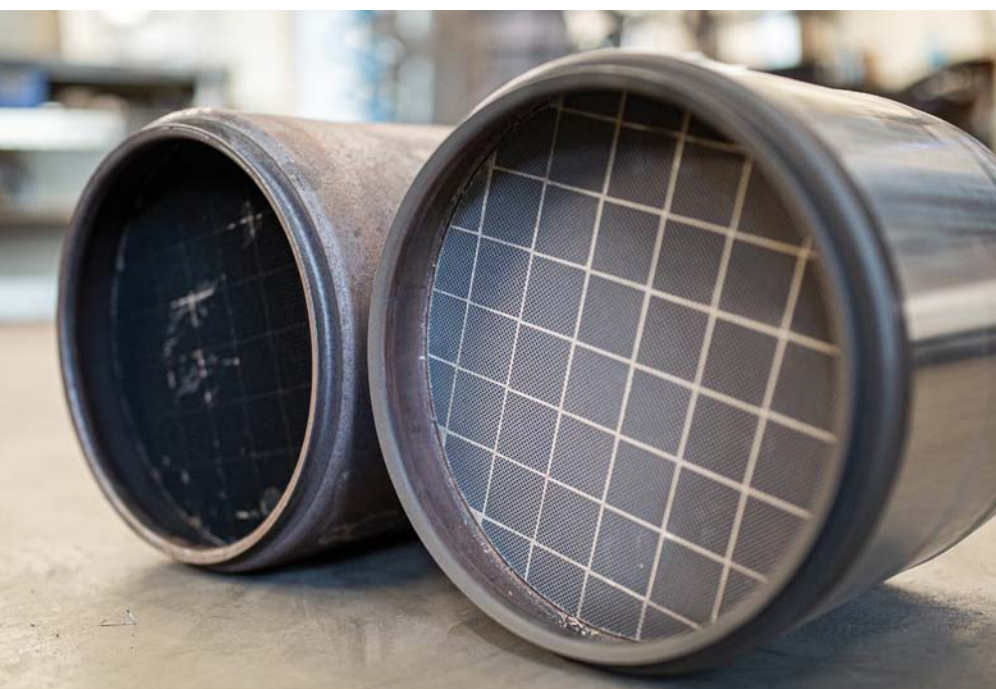
Z LEWEJ: FILTR CAŁKOWICIE ZAPCHANY. Z PRAWYJ: ZREGENEROWANY, GOTOWY DO MONTAŻU
