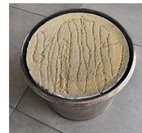
ZNISZCZONY WKŁAD FILTRA. PRAWDOPODOBNIENIE PRZEZ PRÓBĘ UMYCIA MYJKĄ CIŚNIENIOWĄ
