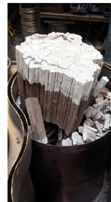
ZNISZCZONY, POKRUSZONY WKŁAD FILTRA DPF
