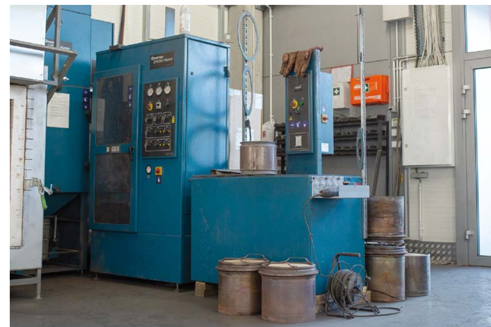
URZĄDZENIE HATRIDGE DPF 300 DO USUWANIA SADZY I POPIOŁU JEST REKOMENDOWANE PRZEZ WIELU PRODUCENTÓW SILNIKÓW
