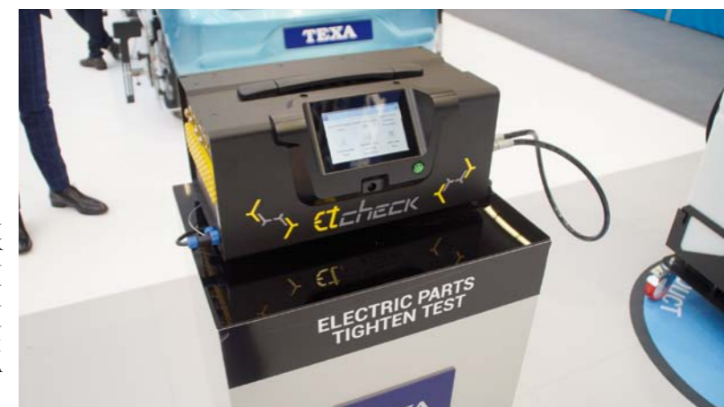
PROTOTYPOWY MIERNIK PRAWIDŁOWOŚCI DZIAŁANIA ZACISKÓW ELEKTRYCZNYCH FIRMY TEXA
