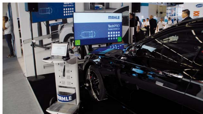
MAHLE – SPRZĘT DO KALIBRACJI SYSTEMÓW WSPOMAGANIA KIEROWCY ADAS
