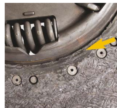
FOT. 2. TARCZA SPRZĘGŁA ZANIECZYSZCZONA OLEJEM LUB SMAREM
