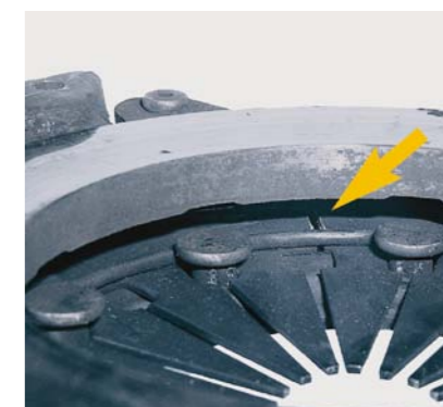
FOT. 7. PĘKNIĘTA SPRĘŻYNA TALERZOWA
