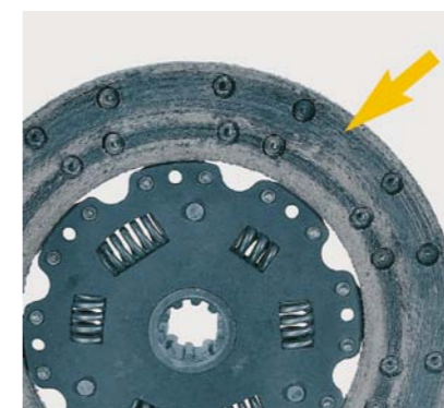
FOT. 5. ŚLADY WYSTĘPOWANIA BRAKU PEŁNEGO KONTAKTU TARCZY SPRZĘGŁA Z POWIERZCHNIĄ KOŁA ZAMACHOWEGO
