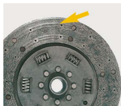
FOT. 1. NADMIERNE ZUŻYCIĘ TARCZY SPRZĘGŁA
