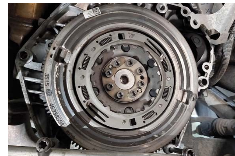
FOT. 6. DKZ W USTAWIENIU GOTOWYM DO MONTAŻU SKRZYNI BIEGÓW
