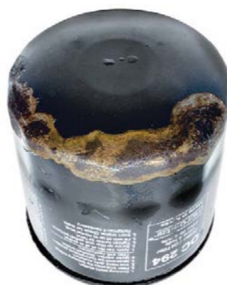
RYS. 4. KORYZJA SPOWODOWANA USZKODZENIEM ZEWNĘTRZNEJ POWŁOKI
