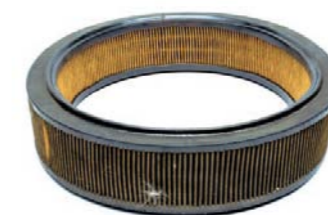
RYS. 9. BARDZO ZABRUDZONY FILTR POWIETRZA – KONIECZNA JEST JEGO WYMIANA
