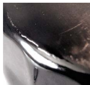
RYS. 1. RYSA NA OBUDOWIE FILTRA POWSTAŁA W WYNIKU PRZECIĄŻENIA ZMIENNEGO NACISKU
