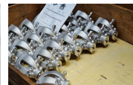
ALUMINIOWE KORPUSY ZACISKÓW NIE NADAJĄ SIĘ DO REGENERACJI – DOSTARCZAJĄ JE ZEWNĘTRZNI PRODUCENCI
