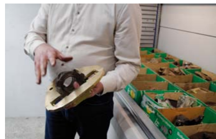
REPOZYTORIUM PODZESPOŁÓW – NA ZDJĘCIU WZORCOWY ZACISK DO SAMOCHODU SAAB
