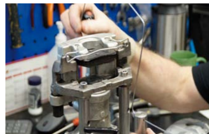
KONTROLA JAKOŚCI ZA POMOCĄ WZORNIKA – SPRAWDZIAN WOLNEJ PRZESTRZENI I KĄTÓW
