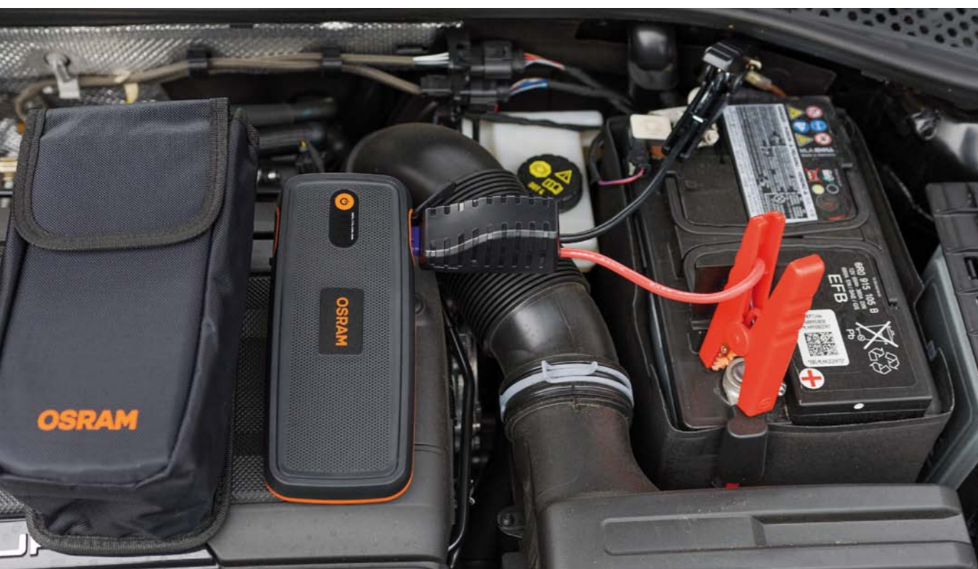
BOOSTER BATTERYSTART OBSL FIRMY OSRAM PODŁĄCZONY DO AKUMULATORA W SAMOCHODZIE
