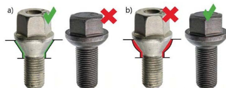
RYS. 1. BŁĘDY W SKOJARZENIU ŚRUBY (NAKRĘTKI) MONTAŻOWEJ Z OTWOREM W TARCZY KOŁA. A – SKOJARZENIE POPRAWNE, B – SKOJARZENIE BŁĘDNE
