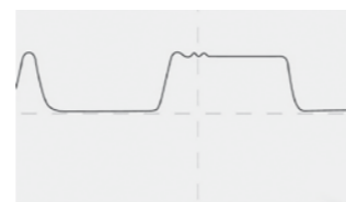
REJESTRACJA SYGNAŁU Z PINU C9 Włączyć zapłon, nacisnąć i zwolnić pedał. Wzrost i spadek wartości sygnału jest zależny od szybkości naciśnięcia i ponownego zwolnienia pedału
