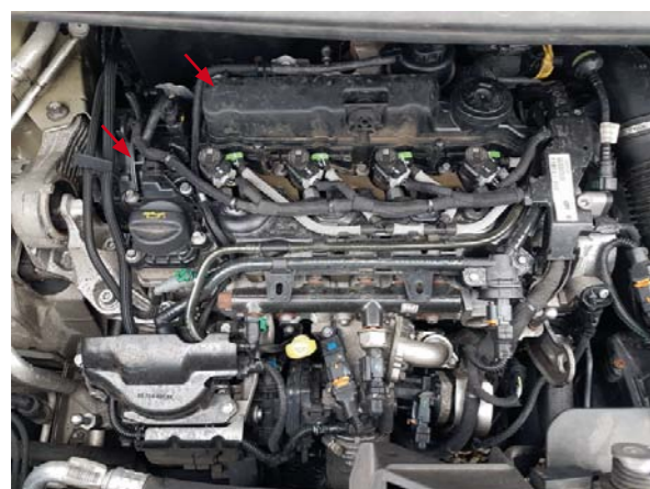
RYS. 1. KOMORA SILNIKA SAMOCHODU PEUGEOT TRAVELLER 2.0 BHDI. OZNACZANIE POKRYWY GŁOWICY I OSŁONY NAPĘDU PASOWEGO UKŁADU ROZRZĄDU
