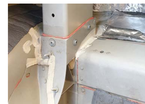
RYS. 6. NITOWANIE UZUPEŁNIANE KLEJENIEM W POŁĄCZENIACH NADWOZIA (TESLA)
