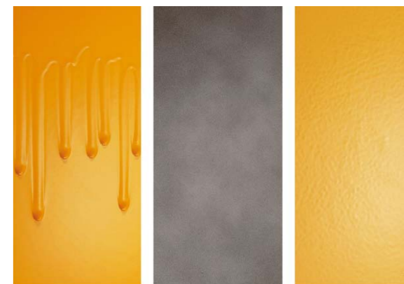
NIEPRAWIDŁOWE USTAWIENIA PISTOLETU MOGĄ DOPROWADZIĆ DO POWSTAWANIA WAD TAKICH, JAK ZACIEKI, CHMURZENIE, SKÓRKA POMARAŃCZY
