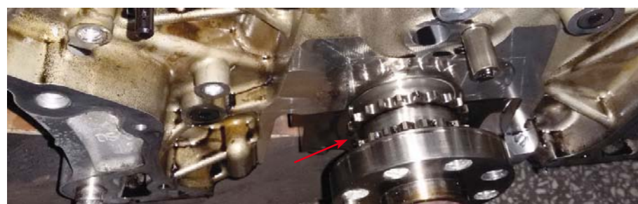
RYS. 1. STAŁE POŁĄCZENIE ZĘBATEK NAPĘDU UKŁADU ROZRZĄDU I POMPY UKŁADU OLEJENIA Z WAŁEM KORBOWYM (OZNACZENIE STRZAŁKĄ) STOSOWANE W SILNIKACH SERII N. DOTYCZY JEDNOSTEK N47X ORAZ N57X
