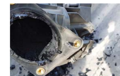
RYS. 7. PRZYKŁAD ZANIECZYSZCZONEGO KOLEKTORA UKŁADU DOLOTOWEGO SILNIKA N47X
