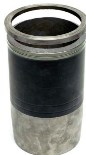
RYS. 2. UŁAMANY KOŁNIERZ TULEI CYLINDROWEJ
