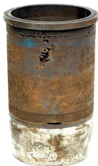
RYS. 1. TULEJA CYLINDROWA Z USZKODZENIAMI KAWITACYJNYMI. OSTRE KRAWĘDZIE WZORÓW WIDOCZNE SĄ W POWIĘKSZENIU PO PRAWEJ STRONIE
