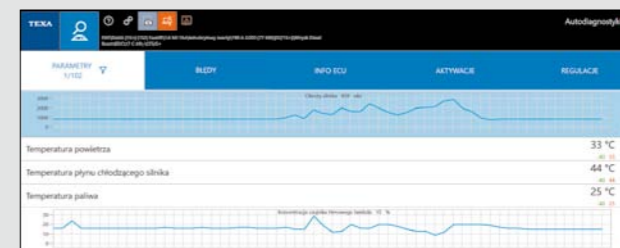
RYS. 9. PARAMETRY PRACY NOWEJ SONDY LAMBDA PO WYMIANIE I ADAPTACJI
