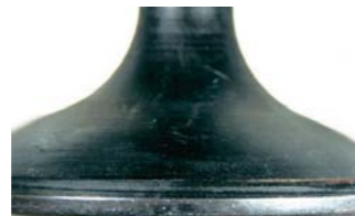
RYS. 14. ZDEFORMOWANY TALERZYK ZAWORU (KSZTAŁT TULIPANA)
