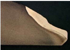
RYS. 12. SILNIE ZUŻYTA POWIERZCHNIA USZCZELNIENIA
