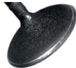
RYS. 15. LINIOWE ŚLADY STYKOWE NA ZDEFORMOWANYM TALERZYKU ZAWORU
