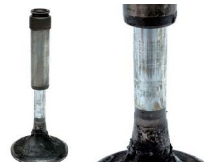
RYŚ. 1A. ZAWÓR Z WIDOCZNYMI ZATARCAMI
