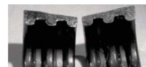
RYŚ. 6. ZDEFORMOWANIE PODKŁADEK POD GNIAZDA ZAWOROWE NA PROGACH CIĄGOWYCH
