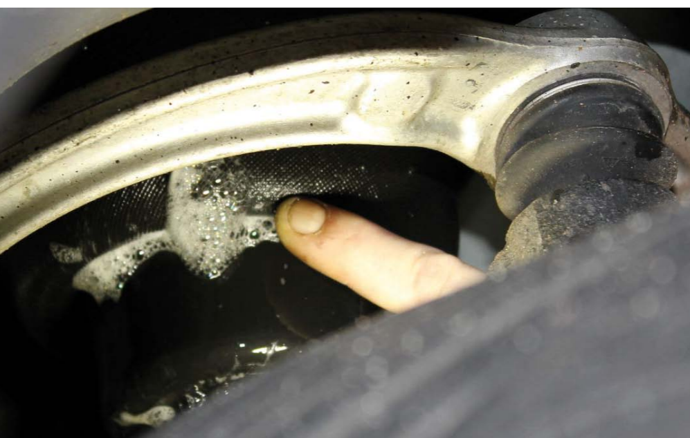
WYKRYWANIE NIESZCZELNOŚCI MIECHA
