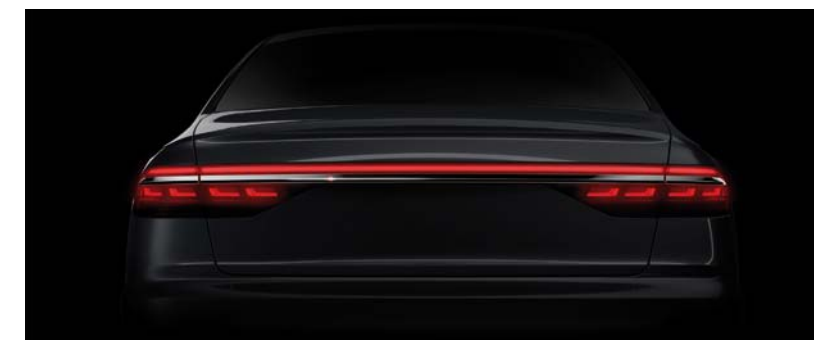
KOMPOZYCJA TYLNYCH LAMP WYPRODUKOWANYCH PRZEZ HELLĘ W TECHNOLOGII OLED ZASTOSOWANA W AUDI A8
