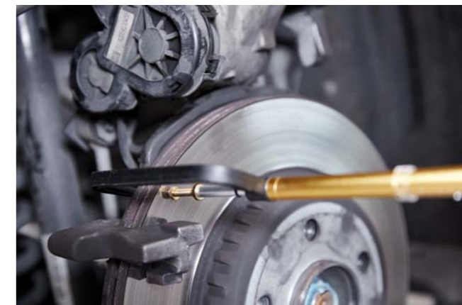
GRUBOŚĆ TARCZY HAMULCOWEJ MOŻNA ZMIERZYĆ ZA POMOCĄ SPECJALNEGO PRZYRZĄDU
