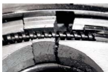
FOT. 16. WYKRUSZENIE PÓLEK PIERŚCIENI TŁOKOWYCH
