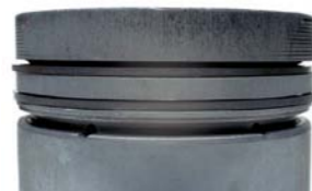
FOT. 4. ZUŻYCIE OSIOWE PIERŚCIENI TŁOKOWYCH
