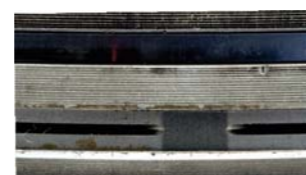
FOT. 5. ZNACZNIE ZUŻYTY PIERŚCIEŃ ZGARNIAJĄCY OLEJ
