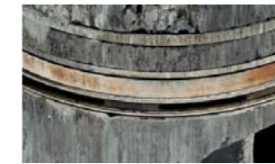
FOT. 9. RYSY I PRZYPALONE MIEJSCA NA PIERŚCIENIACH TŁOKA
