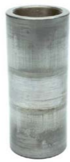
FOT. 6. ZUŻYTY SWORZEŃ
