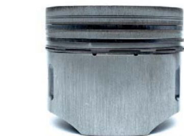
FOT. 1. ZUŻYCIE TŁOKA SPOWODOWANE ZABRUDZENIAMI – SILNE WZDŁUŻNE RYSY
