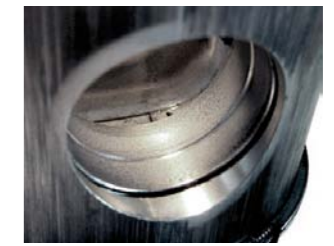
FOT. 11. WŻERY KOROZYJNE W OTWORZE PIASTY SPOWODOWANE ROZCIEŃCZENIEM OLEJEM SILNIKOWYM
