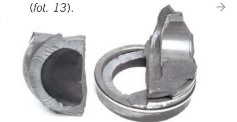
FOT. 13. TŁOK POJAZDU UŻYTKOWEGO ZNISZCZONY PRZEZ UDERZENIE CIECZY
