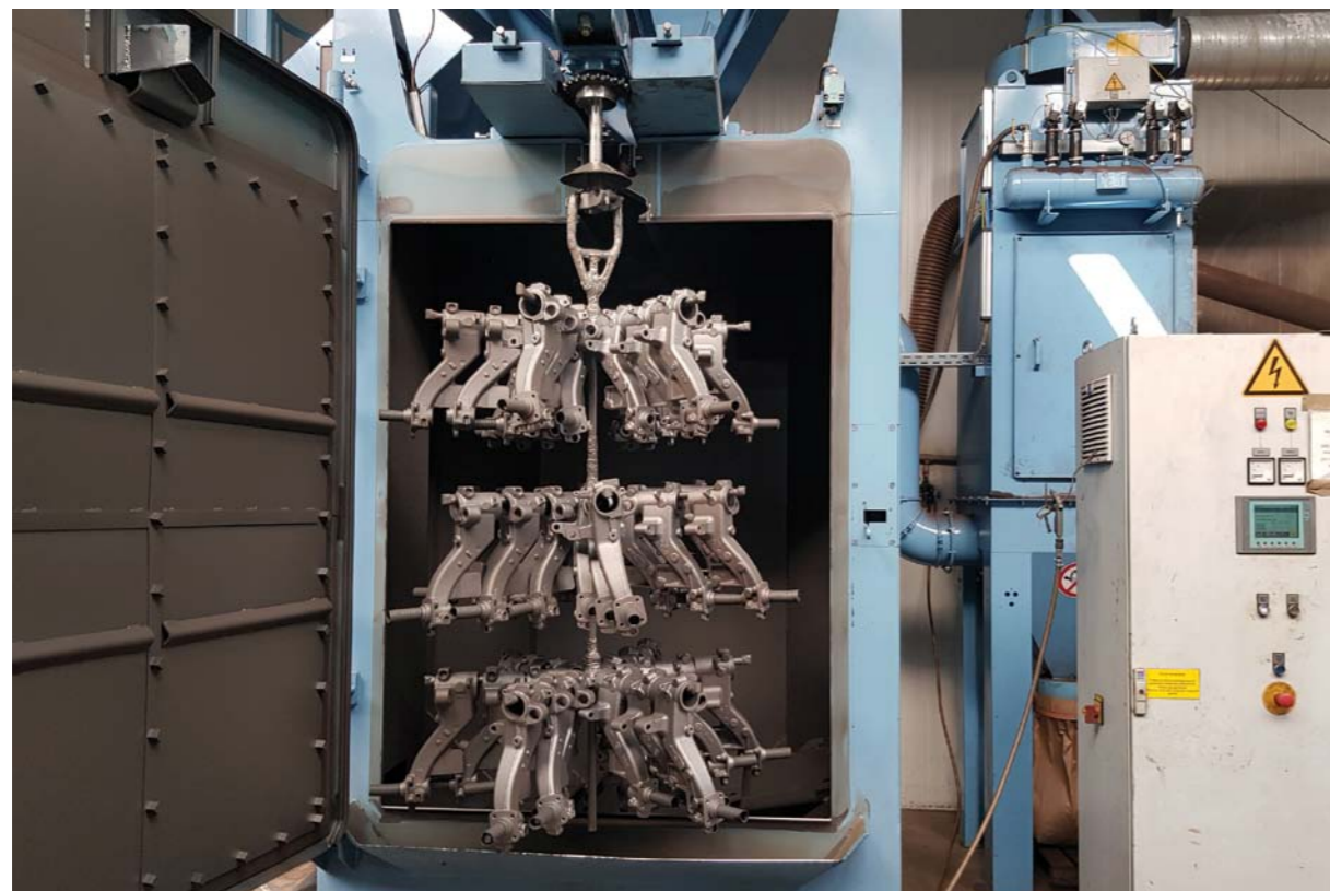
ELEMENTY BELEK OCZYSZCZANE SĄ STRUMIENIOWO W ŚRUTOWNICACH
