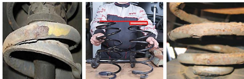
USZKODZENIA SPRĘŻYN ZAWIESZENIA
