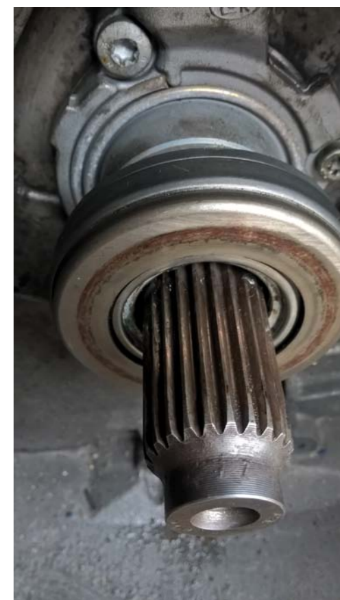
FOT. 2. ZUŻYTY WAŁEK SPRZĘGŁOWY
