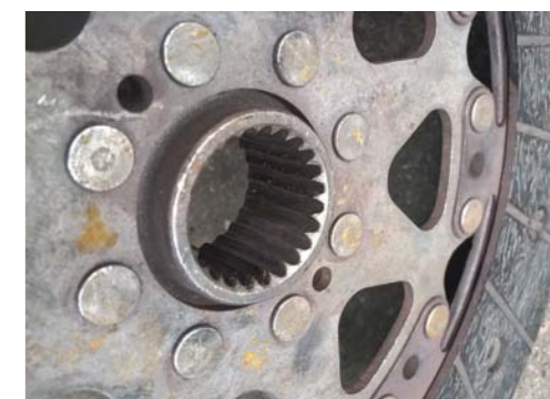
FOT. 3. WYPRACOWANY WIELOKLIN ZDEMONTOWANEJ TARCZY
