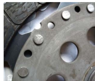
FOT. 1. STARTE NITY TARCZY SPRZĘGŁOWEJ
