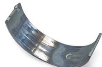
FOT. 11. NIEREGULARNE ZUŻYCIE NA PANEWKACH ŁOŻYSKA
