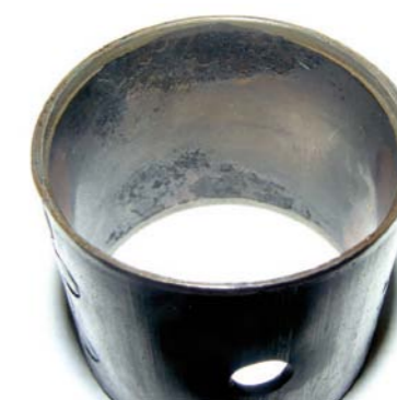
FOT. 20. USZKODZONA TULEJKA KORBOWODOWA
