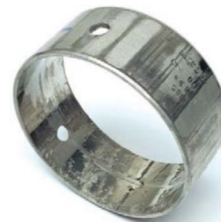
FOT. 17. WYŁAMANIA MATERIAŁU WYWOŁANE MECHANICZNYM OBCIĄŻENIEM ALBO NISKĄ ZDOLNOŚCIĄ NOŚNĄ OLEJU
