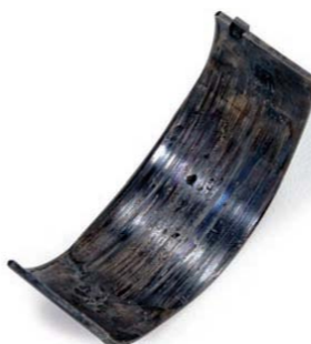
FOT. 14. MOCNO ZUŻYTE I ZDEFORMOWANE ŁOŻYSKO ŚLIZGOWE
