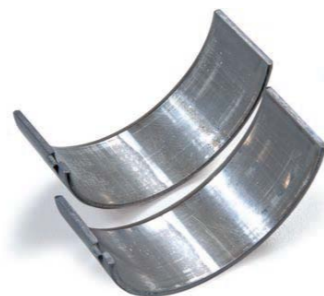
FOT. 13. BŁYSZCZĄCE MIEJSCA NA POWIERZCHNIACH ŚLIZGOWYCH PANEWEK
