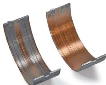
FOT. 1. WYRAŹNE RYSY NA POWIERZCHNI GŁADZI ŁOŻYSK ŚLIZGOWYCH
