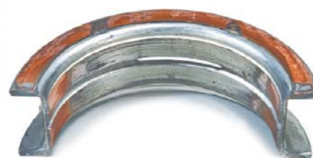
FOT. 4. ZUŻYCIE NA POWIERZCHNI ŚLIZGOWEJ W POBLIŻU FUGI ROZDZIELAJĄCEJ ŁOŻYSKO ŚLIZGOWEGO
