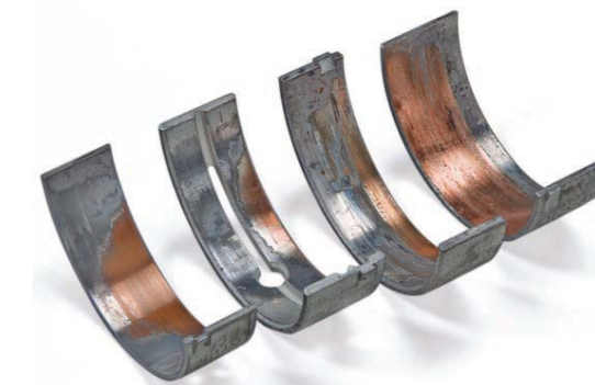
FOT. 9. NIERÓWNOMIERNE ZUŻYCIE NA ŁOŻYSKACH ŚLIZGOWYCH
