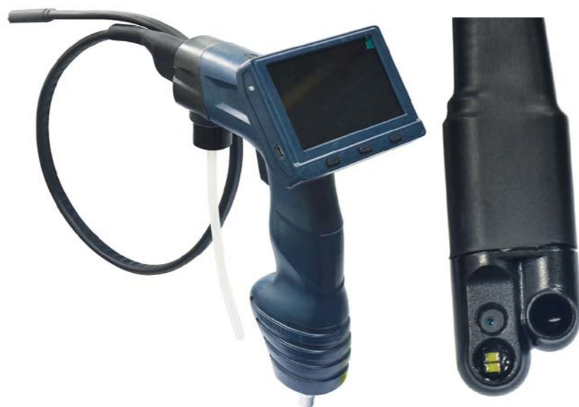
KAMERA Z SONDĄ DO CZYSZCZENIA KLIMATYZACJI. PO PRAWEJ: SPECJALNA SONDA Z KAMERĄ I DYSZĄ DZIAŁAJĄCĄ PROSTOPADLE DO CZYSZCZONEJ POWIERZCHNI
