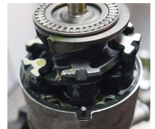
OLEJ ZANIECZYSZCZONY ŚRODKIEM USZCZELNIAJĄCYM – WIDOCZNE ZANIECZYSZCZENIA NA PŁYTCIE WYCHYLNEJ I TŁOKACH
