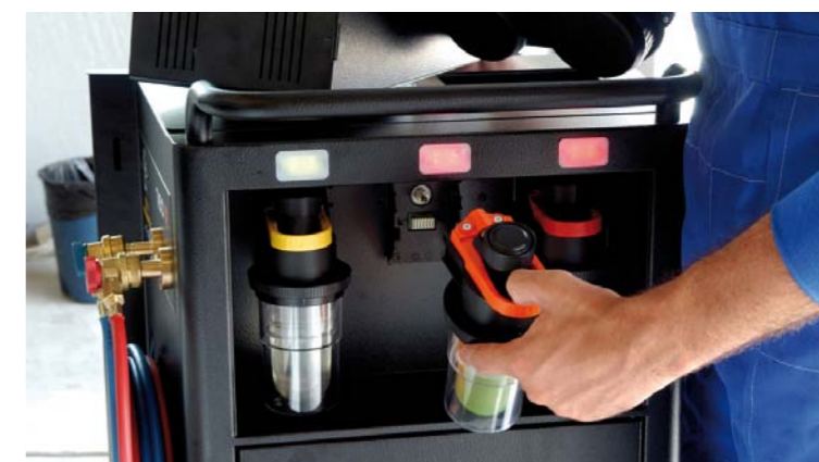
FOT. 2. HERMETYCZNE ZBIORNIKI NA OLEJ ŚWIEŻY ORAZ BARWNIK UV (TEXA KONFORT 760R)
