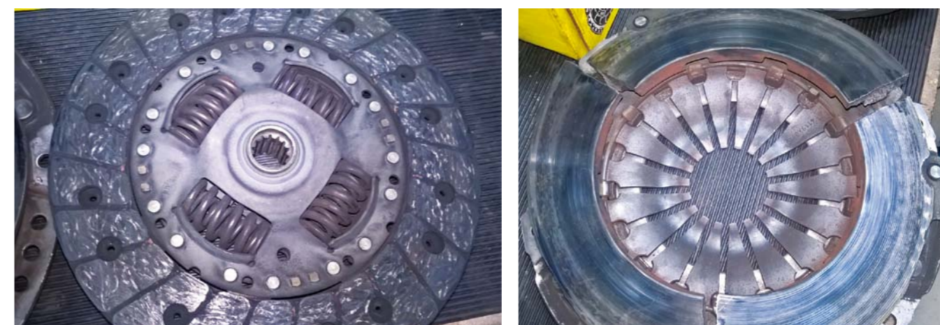
PĘKNIĘCIE DOCISKU SPRĘGŁA BĘDĄCE EFEKTEM ZAMONTOWANIA KOŁA ZAMACHOWEGO O NIEWŁAŚCIWEJ GŁĘBOKOŚCI
