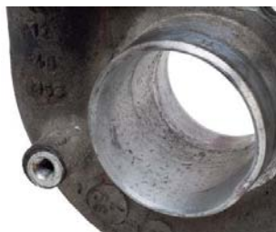
FOT. 16. UDERZENIA CIAŁ OBcych W KANALE SSĄCYM KORPUSU SPRĘŻARKI
