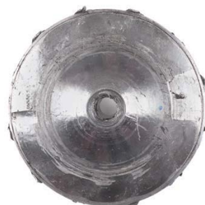
FOT. 19. WGNIECENIA OD TYŁU WIRNIKA SPRĘŻARKI
