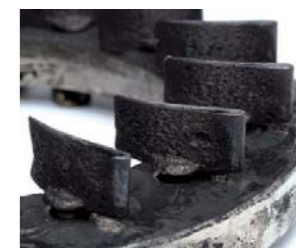
FOT. 14. USZKODZONE KIEROWNICE POWIETRZA W ZESPOLE VTG
