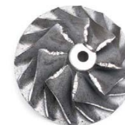
FOT. 15. WIRNIK SPRĘŻARKI USZKODZONY PRZEZ CIAŁA OBCE
