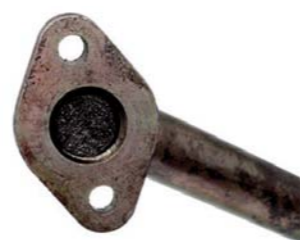
FOT. 12. PRZEWÓD POWROTNY OLEJU ZANIECZYSZCZONY NAGAREM
