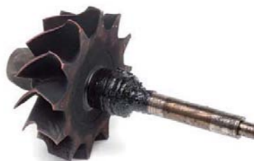
FOT. 11. NAGAR OLEJOWY PO STRONIE TURBINY
