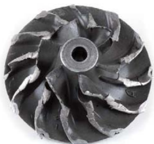
FOT. 1. WIRNIK SPRĘŻARKI PO UDERZENIU W KORPUS
