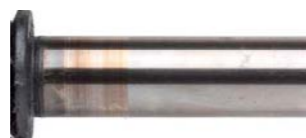
FOT. 4. NAPAWANY NA WAŁKU MATERIAŁ ŁOŻYSKA
