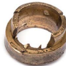
FOT. 7. ZNISZCZONE ŁOŻYSKO PROMIENIOWE
