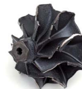
FOT. 9. WIRNIK TURBINY PO OTARCIU SIĘ O KORPUS
