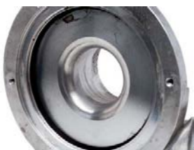
FOT. 2. ŚLADY TARCIA W KORPUSIE SPRĘŻARKI
