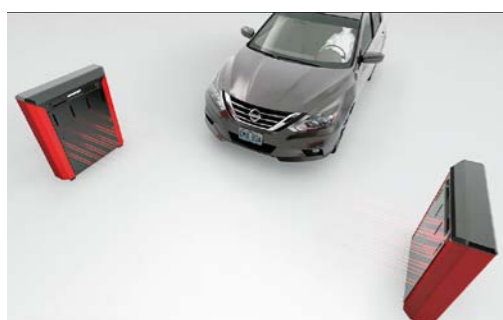
TRWAJĄCE KILKA SEKUND BADANIE ODBYWA SIĘ AUTOMATYCZNIE PODCZAS PRZEJAZDU AUTA MIĘDZY DWIEMA KOLUMNAMI
