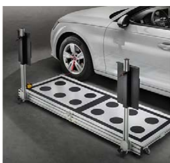
FOT. 6. WYPOSAŻENIE URZĄDZENIA W KÓŁKA POZWALA NA WYKONYWANIE WSZYSTKICH CZYNNOŚCI PRZEZ JEDNĄ OSOBĘ
