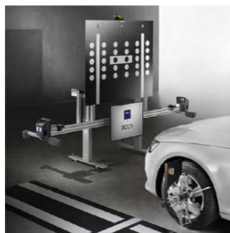
FOT. 7. MAŁA WAGA CZUJNIKÓW I BRAK PRZEWODÓW POŁĄCZENIOWYCH MIĘDZY PRZEDNIAMI A TYLNYMI SENSORAMI ZAPEWNIĄ WYGODĘ UŻYTKOWNIKA
