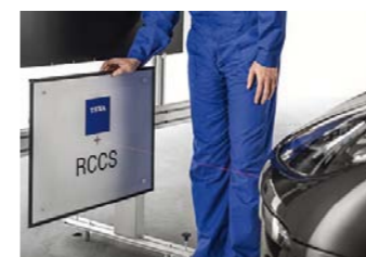
FOT. 2. PRZESUWNY ODBŁYŚNIK WYPOSAŻONY W CENTRALNY LASER DO USTAWIANIA WZGLĘDEM RADARU CZOŁOWEGO
