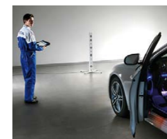
FOT. 4. URZĄDZENIE KALIBRACYJNE IR, UMIESZCZONE PRZED POJAZDEM, SYMULUJE OBECNOŚĆ OBIEKTU EMITUJĄCEGO CIEPŁO
