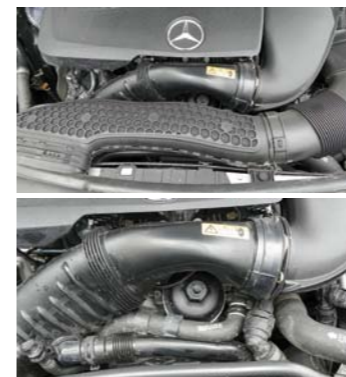
FOT. 6. MIEJSCE MONTAŻU FILTRA OLEJU W KOMORZE SILNIKA W MERCEDESIE C200. SILNIK M264
