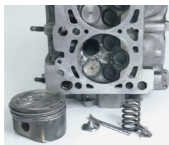
FOT. 5. TYPOWY WYGLĄD USZKODZENIA PO ZŁAMANIU ZAWORU
