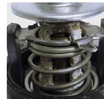
FOT. 11. NIEAUTORYZOWANE DODATKI DO CZYNNIKA CHŁODNICZEGO POWODUJĄ ROZKŁAD ALUMINIUM
