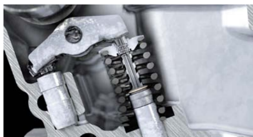
FOT. 1. UKOŚNIE OSADZONA SPRĘŻYNA ZAWORU
