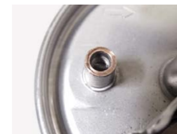
FOT. 9. USZCZELKA ŚRUBY ODWADNIAJĄCEJ PRZY FILTRZE OLEJU NAPĘDOWEGO KL 154
