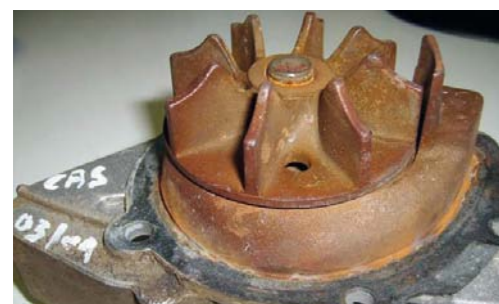
RYS. 3. KORYZJA W UKŁADZIE CHŁODZENIA
