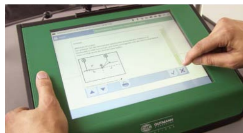
URZĄDZENIE DIAGNOSTYCZNE KOMUNIKUJE SIĘ ZE STEROWNIKIEM REFLEKTORÓW I ODBLOKOWUJE MOŻLIWOŚĆ ZMIANY ICH POŁOŻENIA. JEDNOCZEŚNIE WYŚWIETLANE SĄ WSKAZÓWKI UŁATWIWIAJĄCE PRAWIDŁOWE PRZEPROWADZENIE PROCEDURY REGULACYJNEJ
