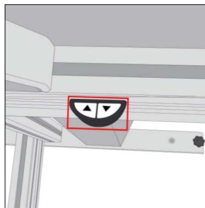
RYS. 5. PRZYCISKI DO REGULACJI WYSOKOŚCI URZĄDZENIA DO KALIBRACJI
